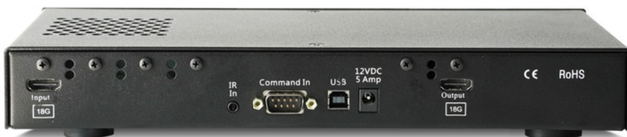
Alle Anschlüsse befinden sich auf der Rückseite des kleinen 4140-C-18G. Da der Videoprozessor zwischen AVR und Beamer installiert wird, reicht ein HDMI-2.0-In und ein HDMI-2.0-Out. Command In (RS232) bietet externe Steuerungsmöglichkeiten. USB und IR In komplettieren das spartanische Anschlussfeld.
