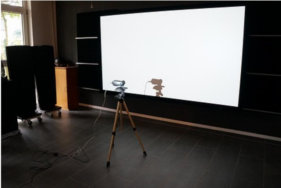
Die Farbgenauigkeit einer Leinwand lässt sich sehr einfach überprüfen: Man misst den Projektor mittels Sensor direkt im Lichtweg ein und richtet im zweiten Schritt den Sensor in Richtung Leinwand. Im Idealfall verändern sich die Messergebnisse zwischen Direkt- und Reflektivmessung nicht. Je größer die Abweichungen, desto schlechter die Leinwand.
