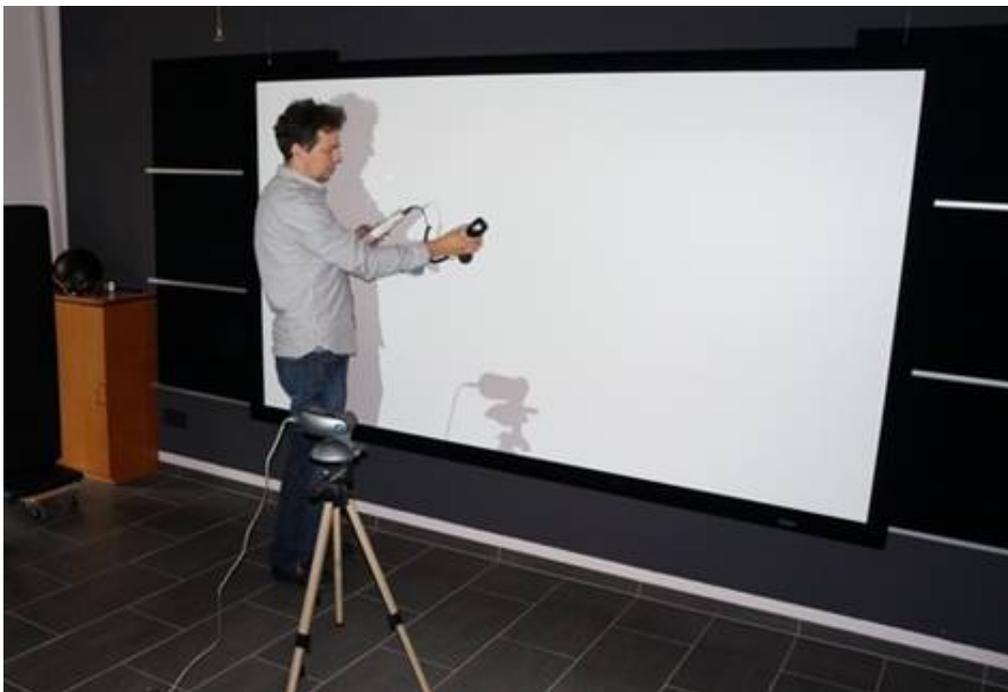
Zunächst ermitteln wir die Lichtleistung des Projektors direkt im Lichtweg mit einem Luxmeter. Daraus lässt sich die reflektierte Soll-Helligkeit bei einem Gainfaktor von 1.0 leicht berechnen.
