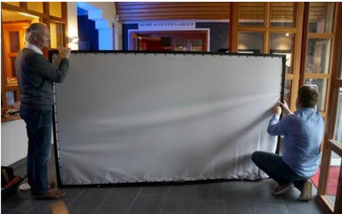
Das Tuchspannen erfordert ein wenig Kraft, geht aber schnell von der Hand und führt direkt zu einer planen und faltenlosen Projektionsfläche.
