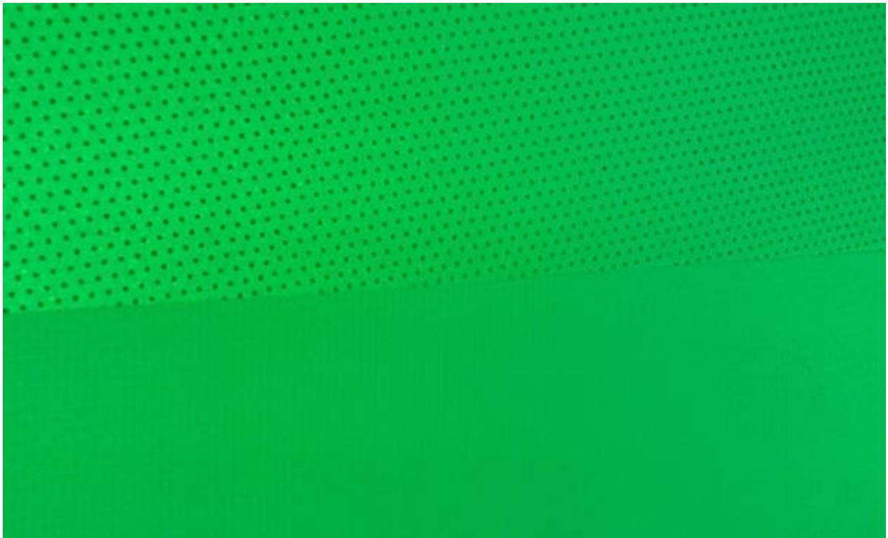
Wie im Foto zu erkennen, sind die Löcher der Perforation deutlich kleiner als die winzigen 4K Pixel (hier bei 2,5m Bildbreite), die native Auflösung des 8 Megapixel Bildes geht nicht verloren. Die Voraussetzungen für eine optimale Auflösungsnutzung sind also erfüllt.
